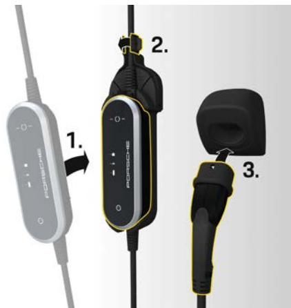
รูป 7: การต่อหน่วยควบคุม
