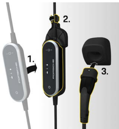
H. 7: Gắn thiết bị điều khiển
