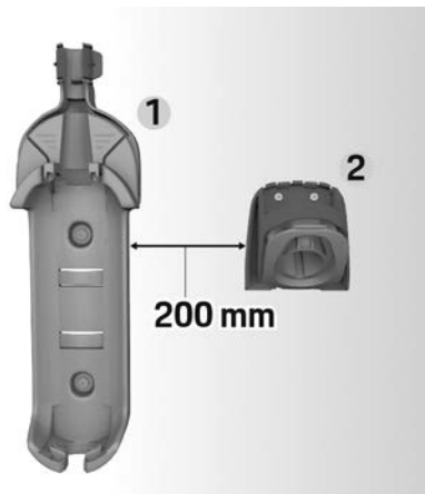
圖 2：壁掛座與接頭固定器的距離
