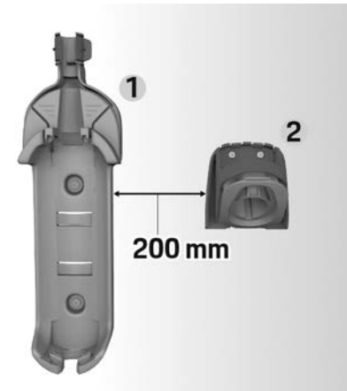
الشكل 2: المسافة من قاعدة التركيب الحائطية إلى مثبت الموصل
