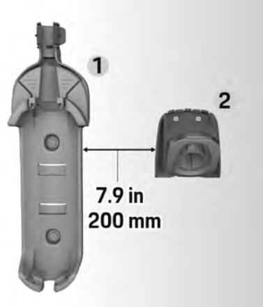
그림 2: 벽걸이 장착 장치에서 커넥터 잠금 장치까지의 거리
