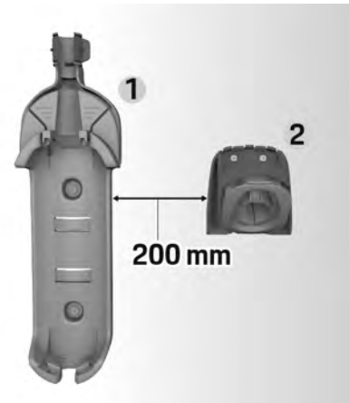
图 2: 从壁挂支架到接头固定器的距离
