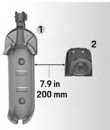
Fig. 2 : Distance entre le support mural et le support de prise
