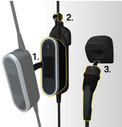
รูป 10: การต่อหน่วยควบคุม
