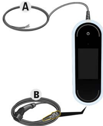
図2: コントロールユニットの接続部
